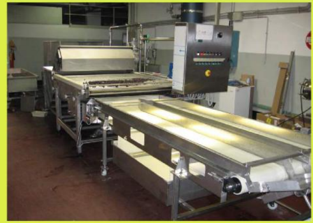
151 Linea di cernita con lampade di contrasto Selection line with opting sorting
