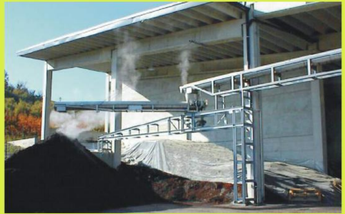
123 Impianto per evacuazione di vinacce esauste in distilleria System to discharge exhausted marc in distillery
