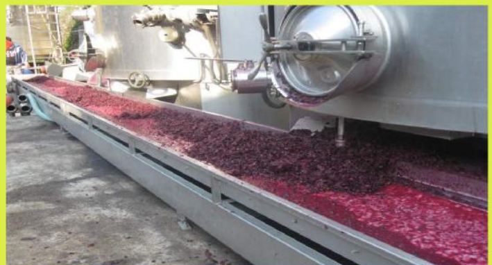
153 Nastro per scarico vinificatori Conveyors to discharge maceration tanks
