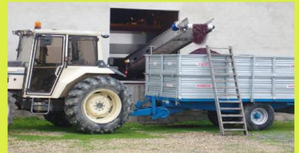
139 Trasportatore a nastro per evacuazione vinacce dalla pressa Belt conveyor to discharge marc from a press
