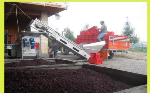
152 Nastro per alimentazione pigiatrice o pressa Conveyors to feed crusher or press
