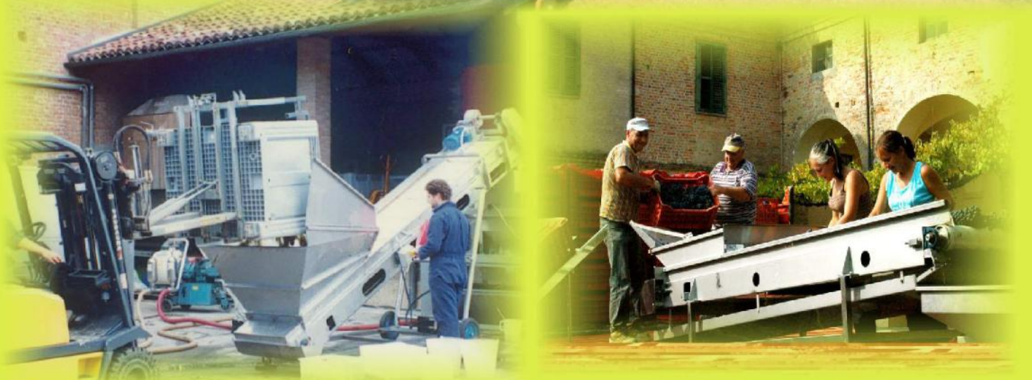
101 Trasportatore dosatore per alimentazione pigiatrice o pressa, caricamento mediante muletto con ribaltatore cassoni Dosing belt conveyor to feed crusher or press, charged with a forklift truck equipped with a system to overturn boxes.
